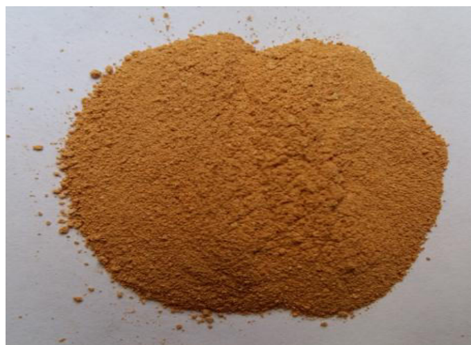
الشكل (9-3) يمثل هيئة المسحوق النانوي لمركب (Ce_x Fe_{0.05}Mg_{0.95-x}O)
