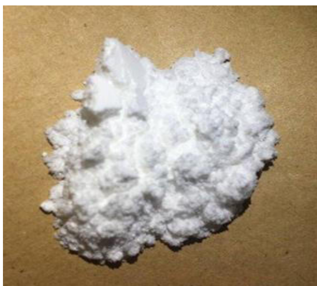
الشكل (3-6) يمثل هيئة مسحوق اوكسيد المغنيسيوم MgO النانوي المحضر
