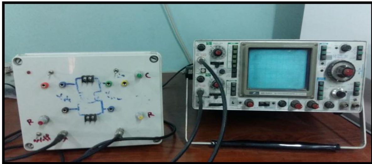
الشكل (18-3) الدائرة الكهربائية الخاصة بفحص حلقة الهستيرة
